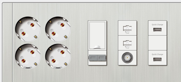
거실 통합 배선기구 2종 (2구 안전형 콘센트 + RJ45 2구 + USB + 공배관 + CATV + 광단자 2구)
